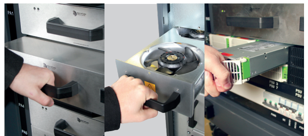
Alimentations, amplificateurs de puissance et ventilateurs redondants et remplaçables à chaud
